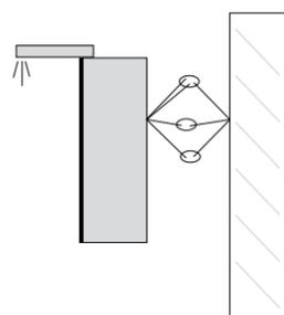
Le câble tétrapolaire du meuble à miroir est connecté au câble tripolaire du mur. Pour cela, 2 lignes doivent être reliées à un raccordement mural.
