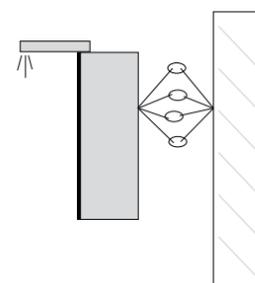
Le câble tétrapolaire de l'armoire de toilette à miroir est connecté au câble tétrapolaire du mur.
