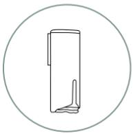
Plastique chromé. Fixation possible sur le montant du caisson, le fond ou la porte. Fixation avec du ruban double face miroir sur la face arrière.
