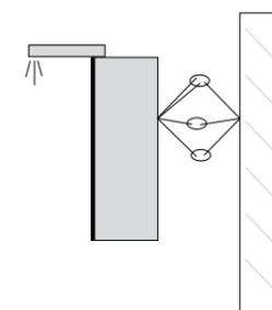
Le câble tétrapolaire de l'armoire de toilette à miroir est connecté au câble tripolaire du mur. Pour cela, 2 lignes doivent être reliées à un raccordement mural.
